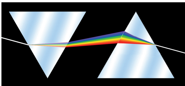
Фигура 1. Експериментална постановка на Нютон – инволюция и еволюция на светлинния лъч
